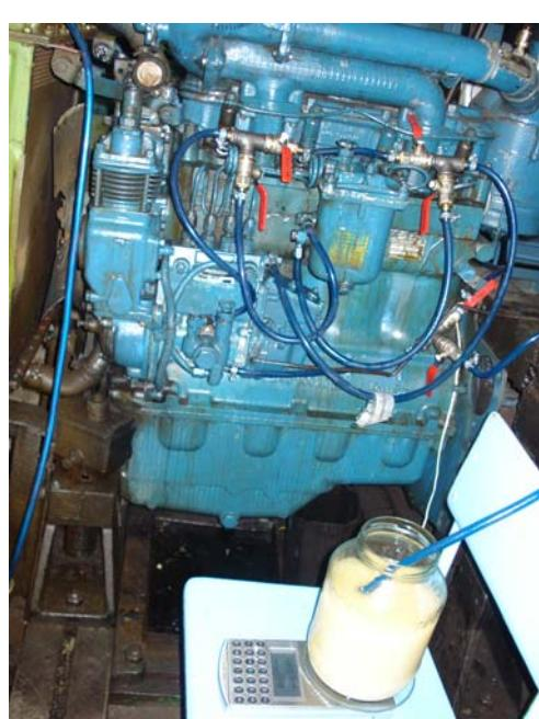
Рисунок 1. Общий вид дизеля Д-240 с установкой для подачи ВТЭ
