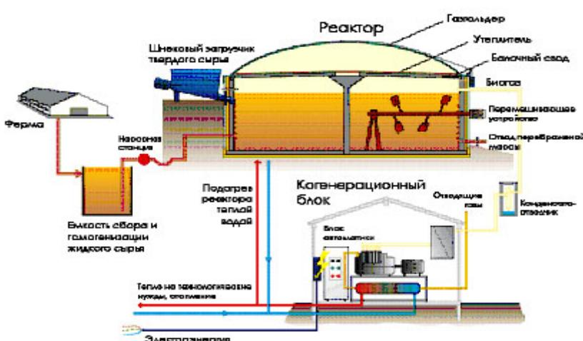
Рисунок 2. Схема биогазовой установки
