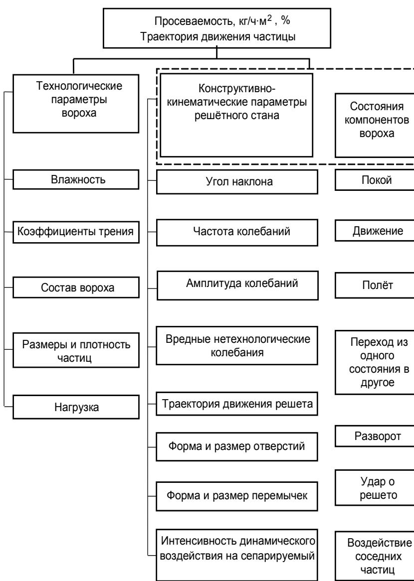
Рис. 1. Схема системы сепарирования зерна на решете
