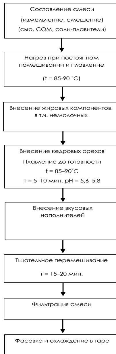
Рисунок 2 Технологическая схема производства нового плавленного сырного продукта
