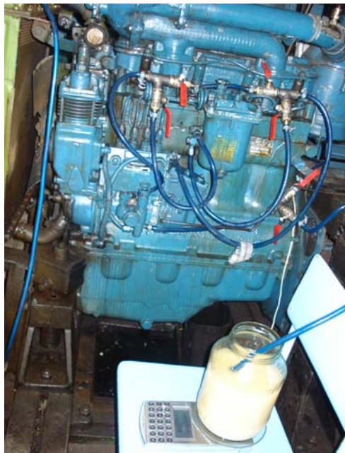
Рисунок 1. Общий вид дизеля Д-240 с установкой для подачи ВТЭ
