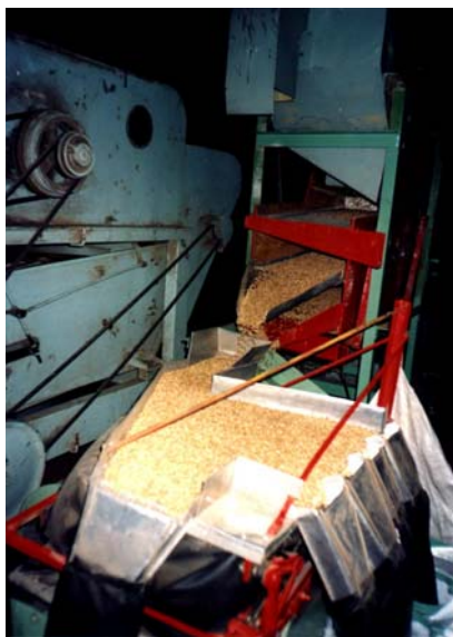
Рисунок. Воздушно-решётная машина производительностью 1 т/ч и вибропневмосепаратор производительностью 0,5 т/ч в работе
