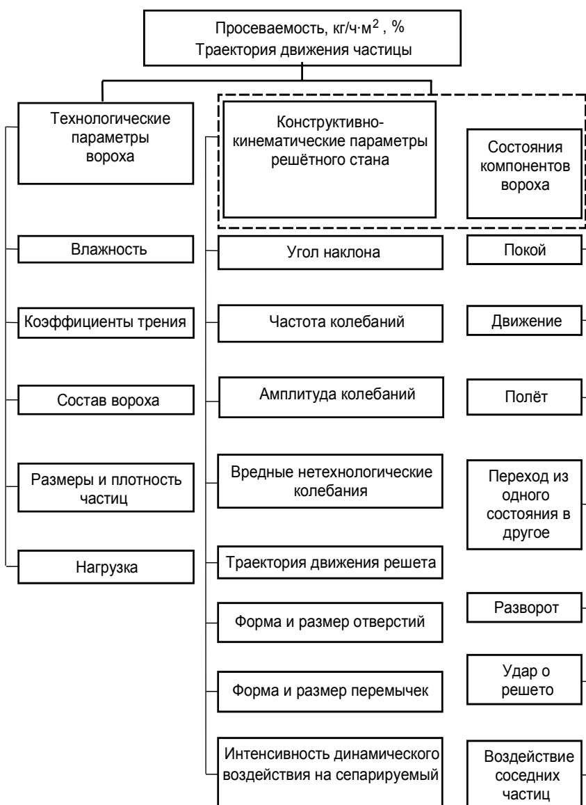
Рис. 1. Схема системы сепарирования зерна на решете
